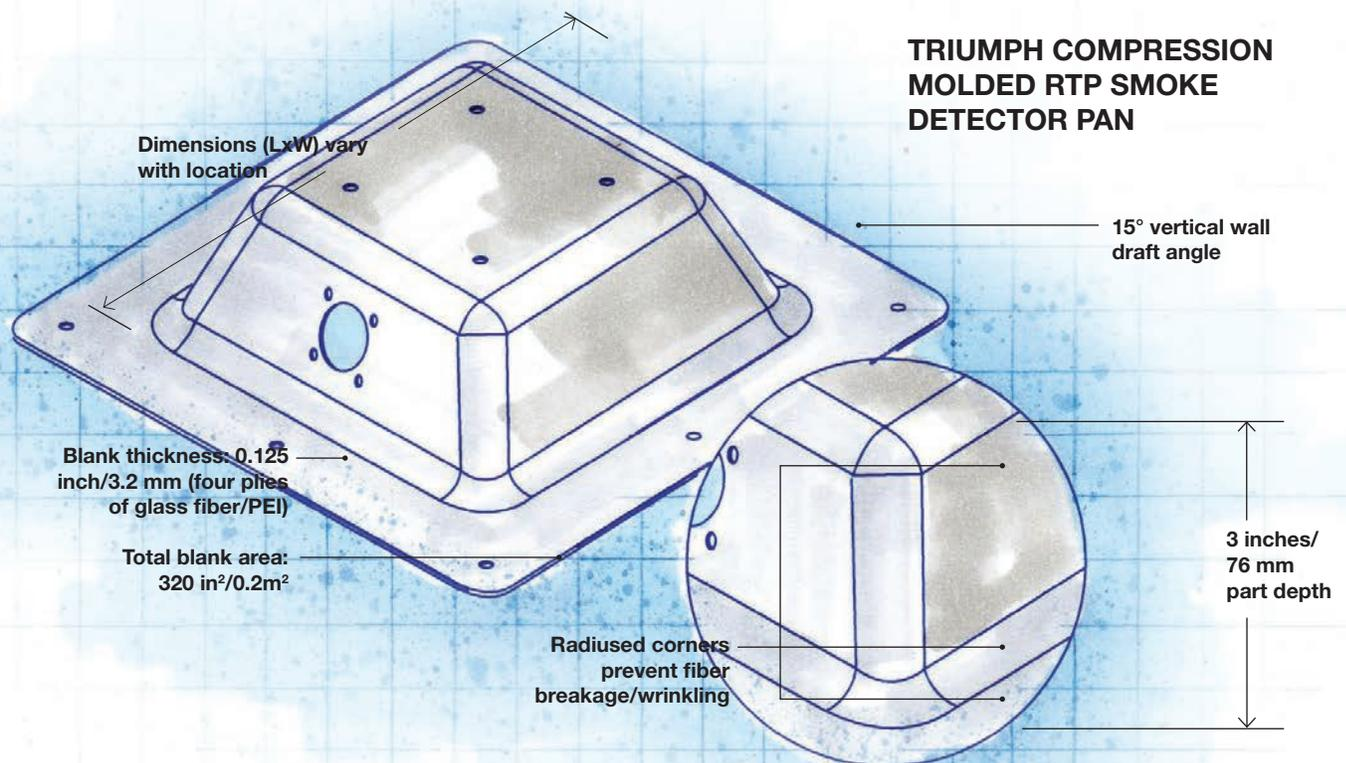
**TRIUMPH COMPRESSION MOLDED RTP SMOKE DETECTOR PAN**
